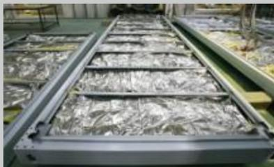
Теплоизоляция (опция): стекловата с односторонним покрытием алюминиевой лентой, алюминиевая лента обращена в сторону помещения, объемный вес  $\geq 14$  кг/м<sup>3</sup>, негорючий класс А.
