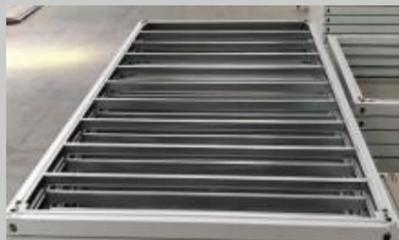
Конструкции и арматура: четырехсторонние основные балки из оцинкованного холоднокатаного стального профиля, четыре угловых элемента приварены к основной балке, образуя раму. Второстепенные балки - оцинкованные холодноформованные тонкостенные С-образные балки, все материалы Q235B (длинная боковая балка нижней рамы предварительно перфорирована).
